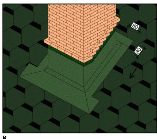
**Рис. 22 Примыкание кровли к трубе дымохода.**
