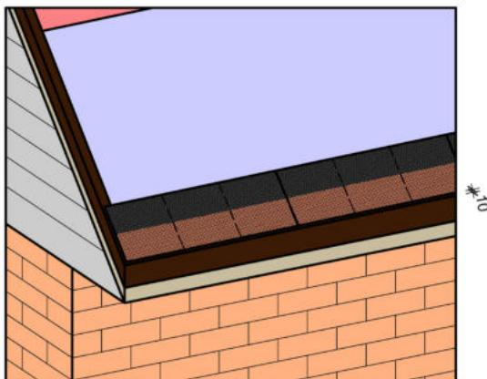
Рис. 11 Схема укладки карнизной черепицы на карнизе.
