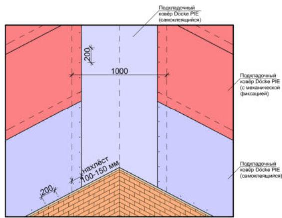
Рис. 7 Схема монтажа подкладочного ковра в ендove и на смежных скатах.
