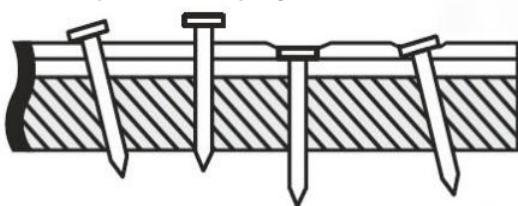
Рис. 3 Пример неправильной забивки гвоздей при монтаже продукции.
